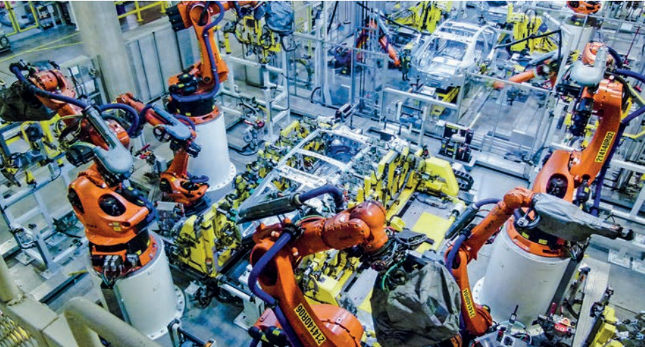
Linka svařené karoserie modelů Superb a Kodiaq, Škoda Kvasiny, foto: Chropyňská strojírna
