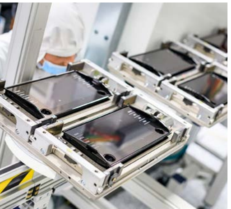
Plně robotizovaná technologie optical bonding, foto: Continental
