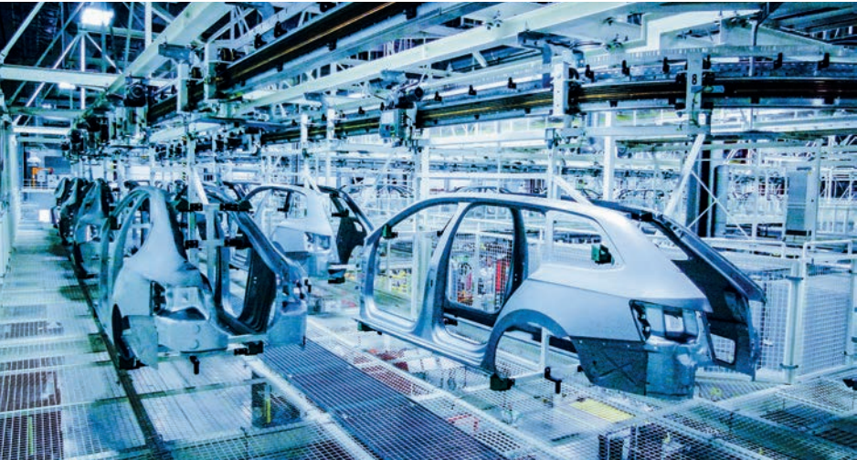
EHB dopravník postranic pro Superb a Kodiaq, Škoda Kvasiny, foto: Chropyňská strojírna
